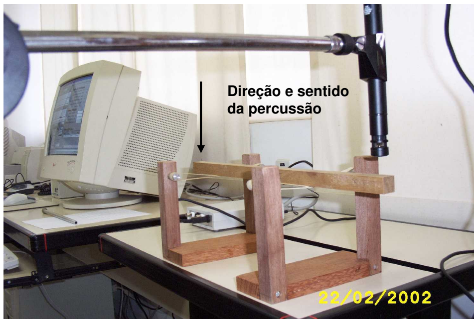
FIGURA 1. Aparato geral utilizado no ensaio de vibração transversal, com detalhe do posicionamento do corpo-de-prova apoiado nos “quartos” e o microfone unidirecional para a captação da vibração.
