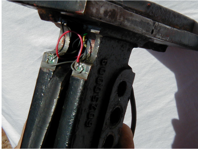
FIGURA 1. Detalhe da instalação dos extensômetros.
