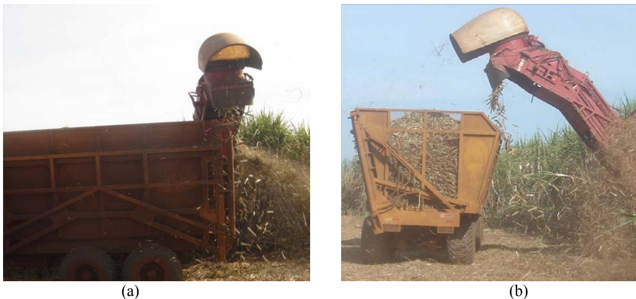
FIGURA 1. (a) Perda por falta de sincronismo. (b) Perda por falta de paralelismo. a) Material lost for lack of synchronization. b) Material lost for lack of parallelism.
