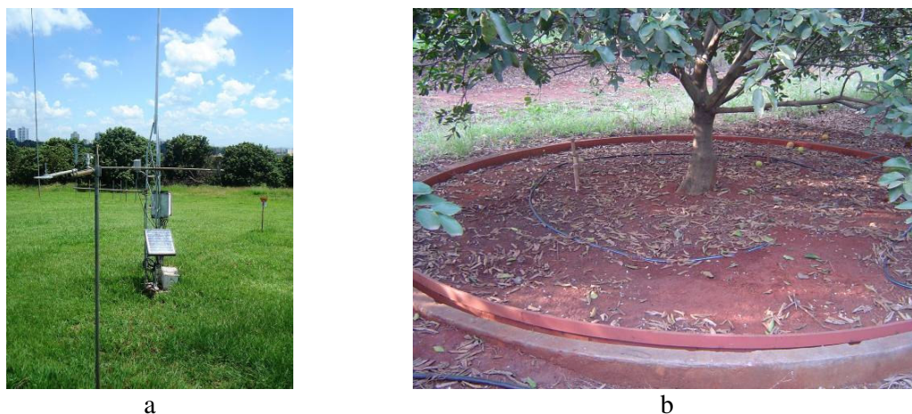
FIGURA 1. Estação meteorológica automática e pomar ao fundo (a); lisímetro de pesagem de 4 m de diâmetro contendo uma planta de limão Tahiti (b). Automatic meteorological station and orchard behind (a); lysimeter of weighting of 4 m of diameter containing a lemon plant Tahiti (b).
