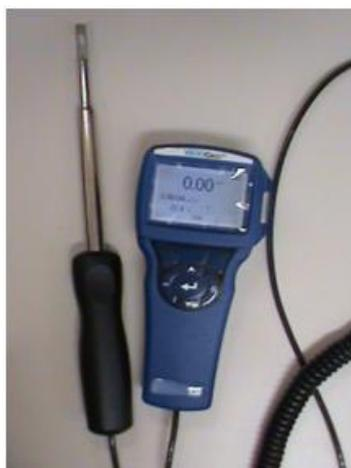
FIGURA 2. Anemômetro de fio quente VelociCalc<sup>®</sup> da marca TSI<sub>TM</sub><sup>®</sup>. **VelociCalc<sup>®</sup> hot-wire anemometer, TSI<sub>TM</sub><sup>®</sup> brand.**
