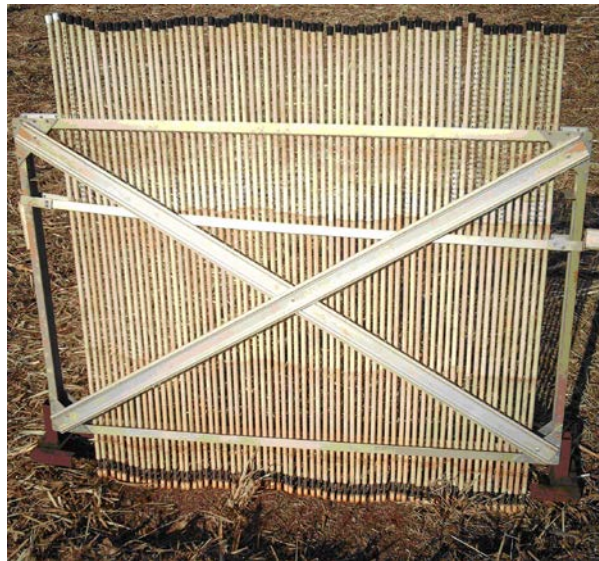
FIGURA 2. Perfilômetro utilizado para avaliar os efeitos no sulco de semente em função dos mecanismos, em sementeira direta. Perfilometry meter used to evaluate the effects of the seed furrows according to the mechanisms in the no-till method.
