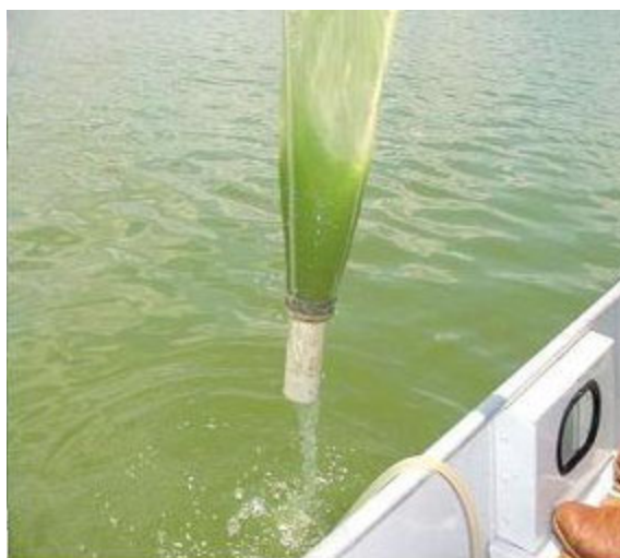
Figura 2 - Coleta da amostra de fitoplâncton - UHE Americana.
