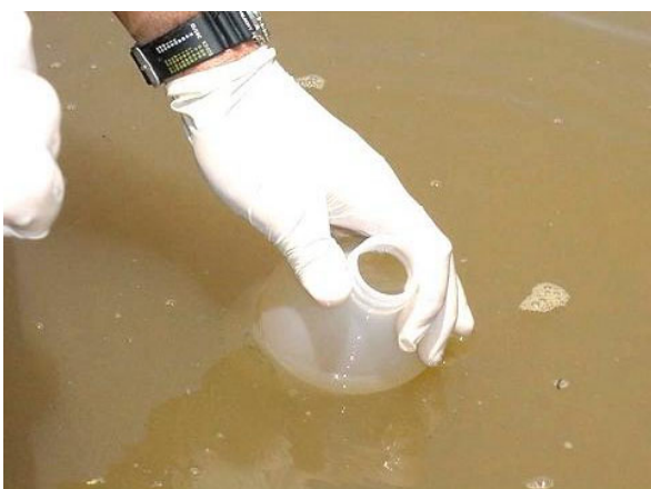
Figura 3 - Coleta da amostra para análise de microcistina - UHE Americana.
