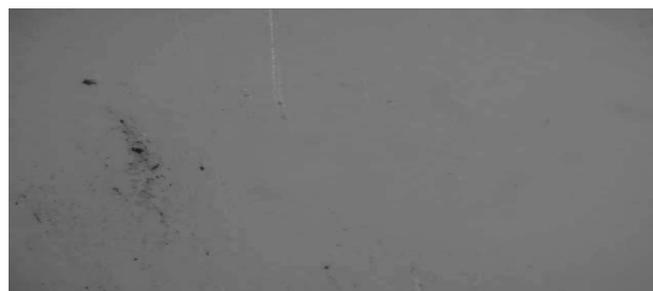
**FIGURA 1.** Microscopia (lupa trinocular Stemi SV6, 65X) da superfície interna do fundo de uma caixa plástica nova tipo monobloco (imagem por CCD Sony DSC 70 de 3.3 Mpixels).
