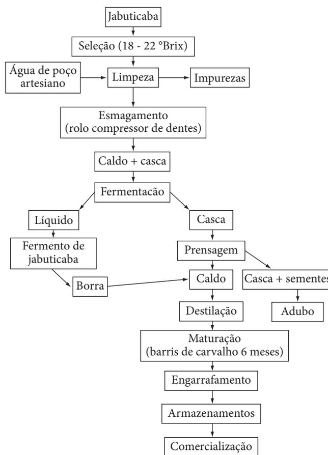
Figura 2. Diagrama de fluxo para fabricação de aguardente de jabuticaba.
