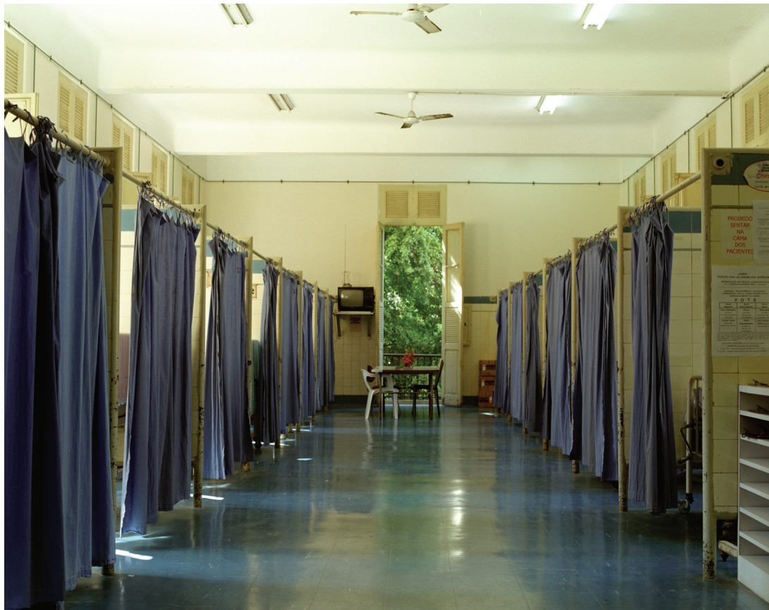
Figura 9 – Na fotografia dessa enfermaria, ainda preservada como em sua inauguração, percebe-se que os preceitos de insolação e aeração foram seguidos a risca: cada leito tem sua própria janela, o pé-direito é alto, e há, em face da porta de entrada da enfermaria, uma porta que dá acesso a uma pequena sacada, que aumenta ainda mais a ventilação da sala. Enfermaria 3 do Hospital Gaffrée e Guinle. Fotografia de Roberto Jesus Oscar e Vinícius Pequeno de Souza, 2003. Acervo do Departamento de Arquivo e Documentação/Casa de Oswaldo Cruz, Fundação Oswaldo Cruz (Fiocruz), Rio de Janeiro.
