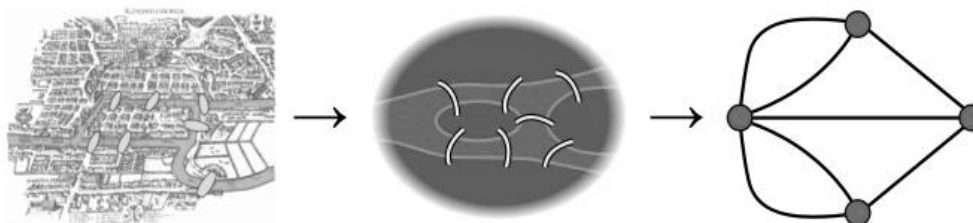
Figura 3 – Transformação das sete pontes em um grafo por Euler.
