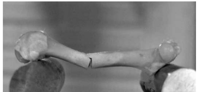
Figura 3 – Demonstração do posicionamento da peça no aparelho para a produção da fratura à esquerda e padrão de fratura obtido à direita
