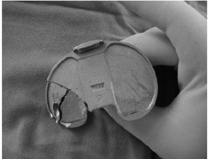
**Figura 3** – Fratura do componente tibial do caso 1
