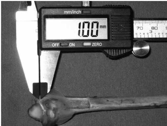
Figura 3 – Degrau articular de 1mm, medido pelo paquímetro digital, e fragmento ósseo fixado com fita adesiva incolor.
