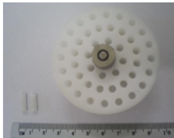
Figura 1 – Pinos de hidrogel PLDLA-co-TMC/PVA e molde usado para confecção dos dispositivos.
