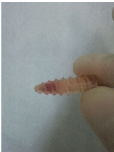
Figura 2 – Parafuso de interferência de poly L,D-lactide íntegro retirado após migração transcutânea.
