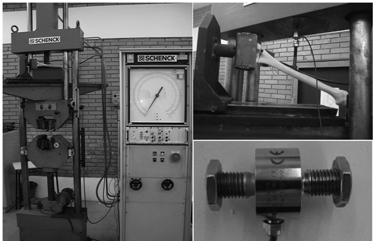
Fig. 3 Máquina de ensaio universal de tração modelo UPM 200 e uma célula de carga HBM U9B (20 KN = 1 mV/V).
