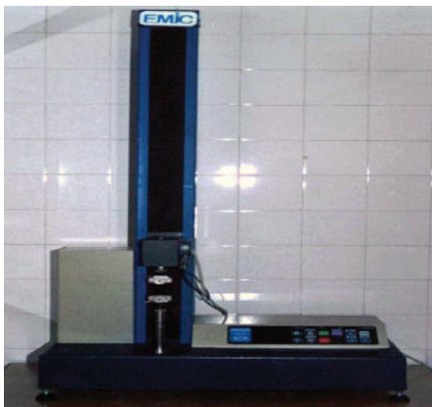
**FIGURA 1** - Máquina universal de ensaio mecânico Emic®, modelo DL-500 MF
