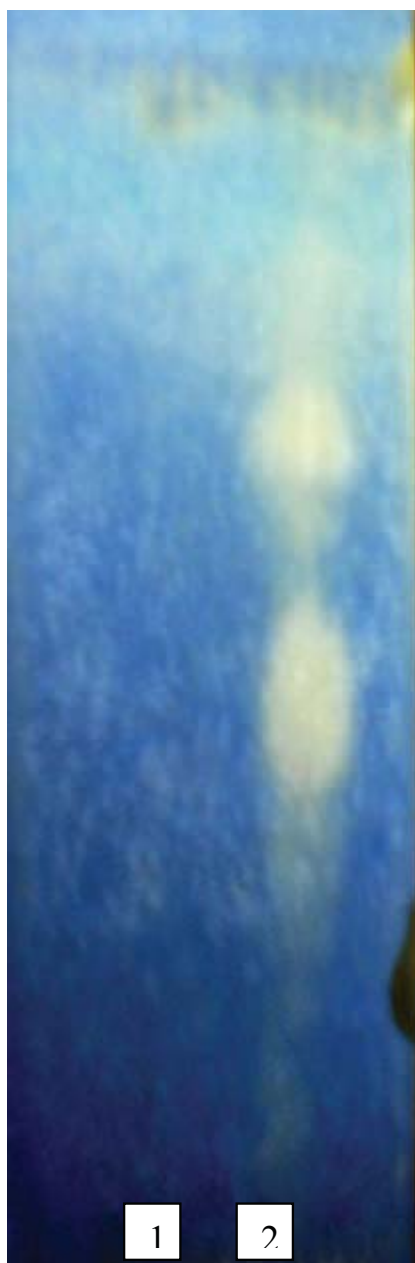
Figura 2. Visualização de Açúcares em Placa Cromatográfica de Gel de Sílica, eluída com Acetato de Etila/Propanol/Água (3,7:3,2:1,3) e revelada com Metaperiodato de Sódio/Benzidina.
