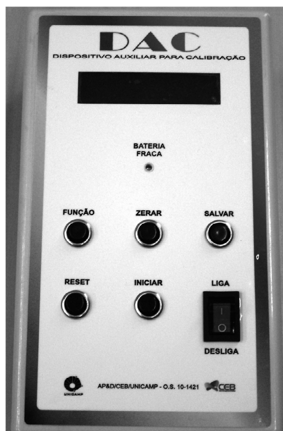
Fig. 3 - Registro fotográfico do dispositivo auxiliar para calibração (DAC) utilizado para as medidas de pressão média de calibração dinâmica
