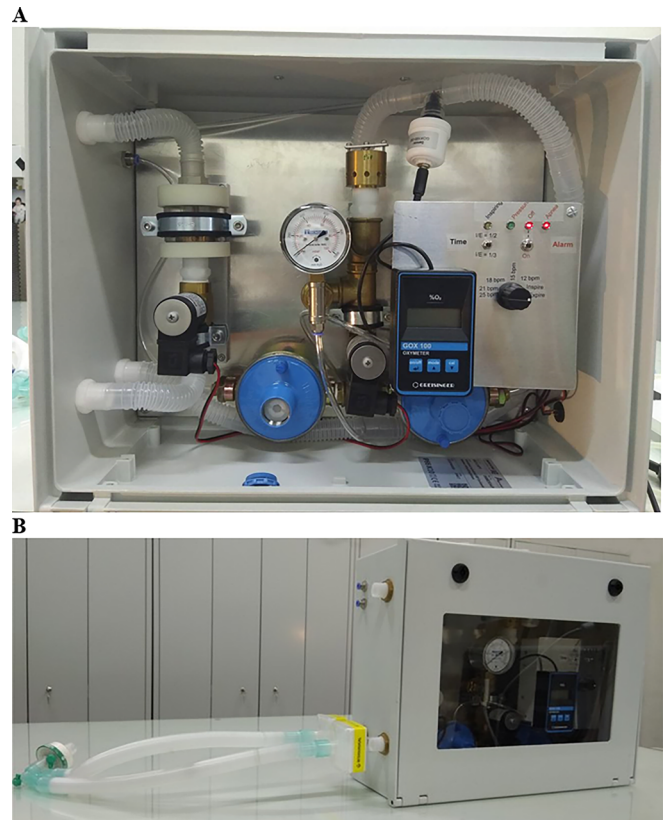
Figura 1 - Implementação prática do ventilador. (A) Vista interna mostrando o painel de comando e os principais componentes. (B) Vista externa com o circuito respiratório padrão de ramo duplo e, na parte superior, a saída de escape e as entradas de ar e oxigênio (conectores azuis).
