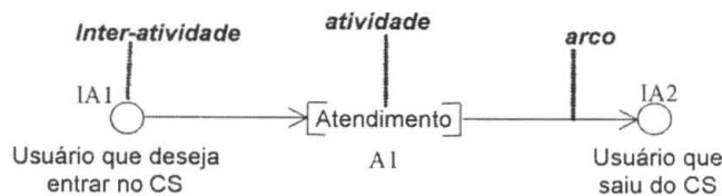
Fig. 4. Exemplo de um PFS com a identificação de seus elementos estruturais. (fluxo de pacientes que procuram um Centro de Saúde)
