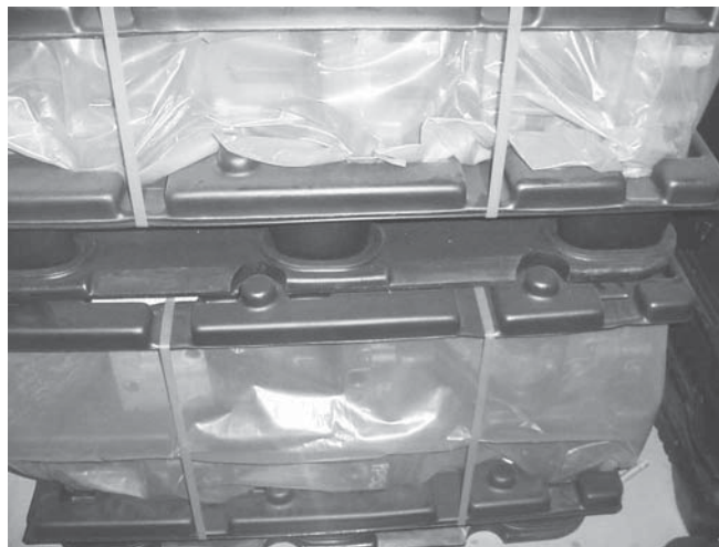
Figura 2: Sistema de travamento do palete com a bandeja no empilhamento.
