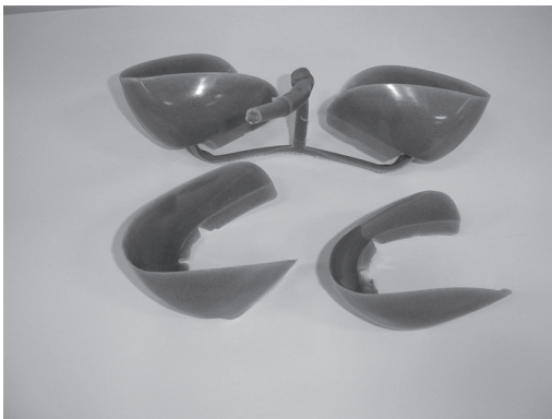
Figura 3. Contraforte injetado reprojetoado.
