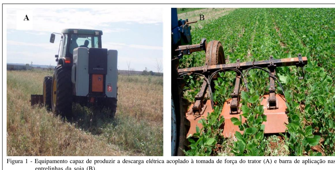
Figura 1 - Equipamento capaz de produzir a descarga elétrica acoplado à tomada de força do trator (A) e barra de aplicação nas entrelinhas da soja (B).
