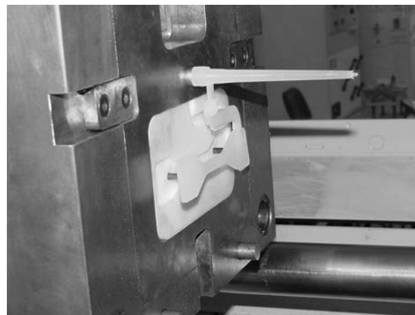
Figura 3. Molde de ABS para injeção de corpos de prova do estudo de caso 2
