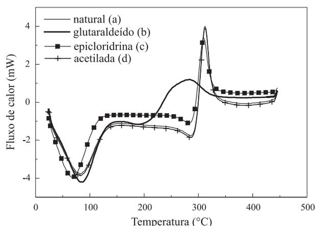
**Figura 8.** Perfil térmico obtido por DSC para as microesferas de quitosana (a) natural, (b) reticulada com glutaraldeído, (c) reticulada com epícloridrina e (d) acetilada.
