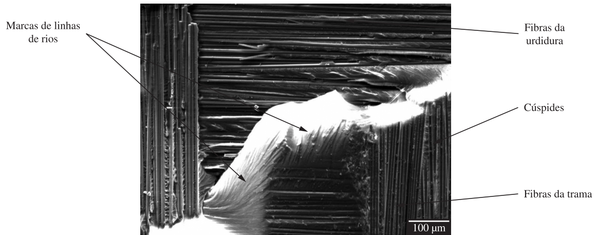
Figura 13. Marcas de linhas de rios na face inferior da superfície de fratura da região rica em resina posicionada em um interstício de entrelaçamento das mechas trama/urdidura.
