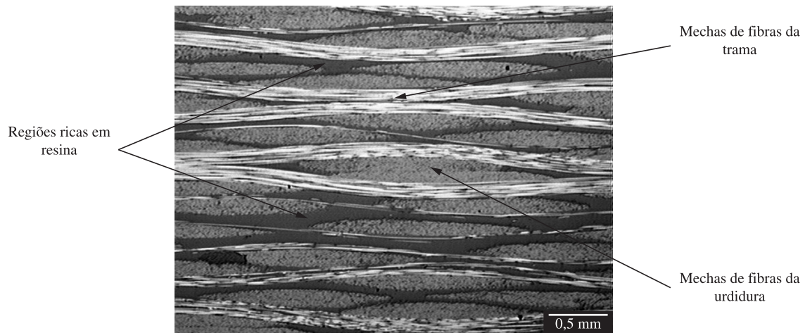
Figura 4. Seção transversal do laminado carbono/epóxi mostrando a regularidade obtida na compactação das camadas de tecido na cura em autoclave.
