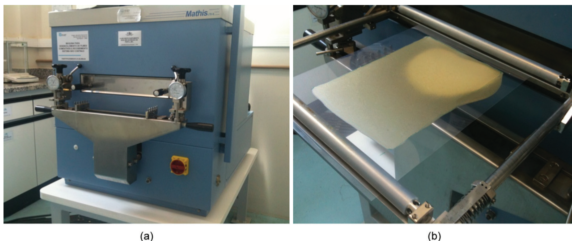
Figura 1. Aspecto externo do acesso à câmara de laminação e aquecimento (A); filme de purê de banana resultante sobre suporte de poliéster (B).
