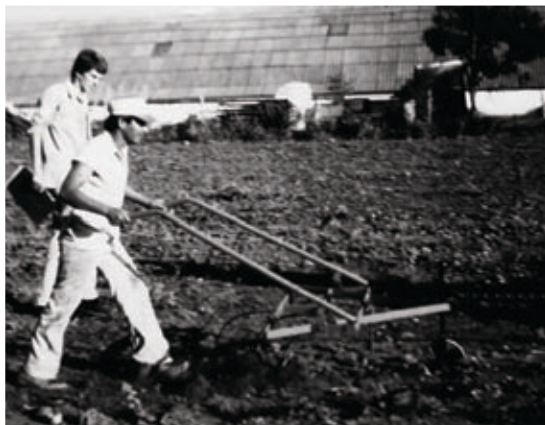
Figura 2. Protótipo do chassi porta-implementos, em estudos de campo.
