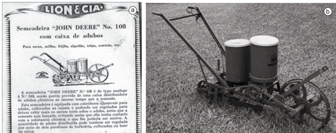
Figura 1. Exemplo de semeadora-adubadora produzida pela John Deere na década de 1920 (a), muito semelhante às disponíveis atualmente no mercado brasileiro (b). Fonte: arquivo do autor e http://www.marchesan.com.br .
