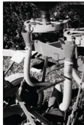
Figura 3. Protótipo de semeadora-adubadora à tração mecânica. Ambos desenvolvidos pelo IAC – Instituto Agrônomo de Campinas. Fonte: arquivo do autor.
