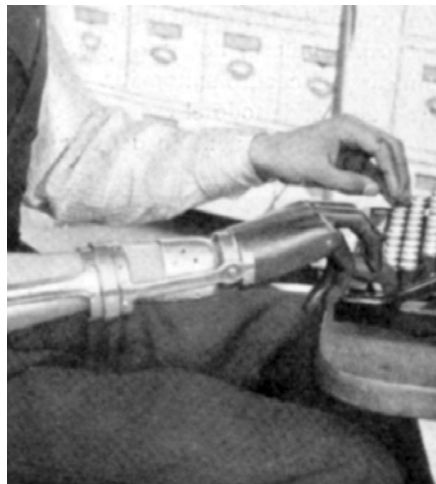
Figura 3 – Modelo de prótesis construida en el Instituto que permitía mejorar la capacidad de la persona amputada de la mano para escribir a máquina.
