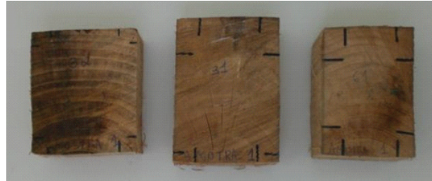
Figura 2 – Corpos-de-prova com marcação dos pontos de medição para determinação das contrações radial e tangencial.
