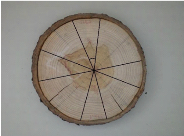
Figura 1 – Esquema de corte dos corpos-de-prova.
