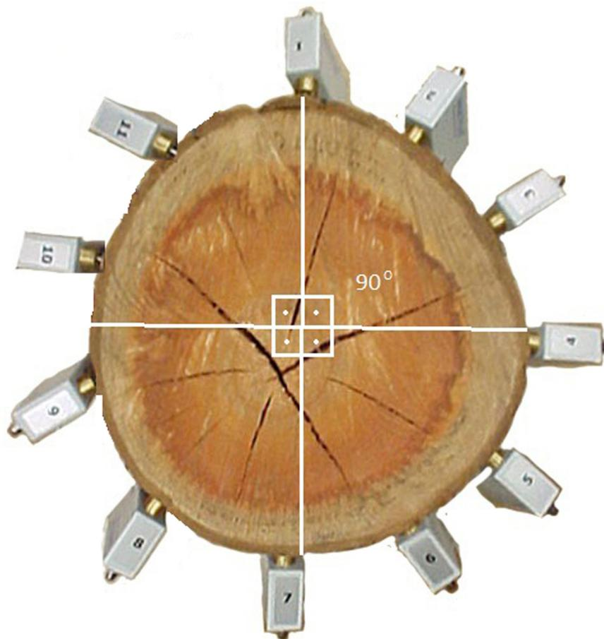
**Figura 1** – Torette de *Eucalyptus saligna* com sensores do tomógrafo de impulso e seção transversal com marcação das posições de penetração da agulha do resistógrafo (a primeira coincidente com o primeiro sensor e as demais a cada 90°).
