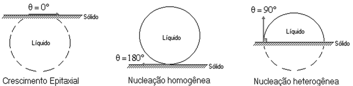
Figura 2. Representação esquemática das formas de crescimento de um sólido a partir de uma fase líquida.
