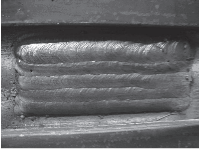
Figura 1. Esquema da sequência dos passes na soldagem multipasse.
