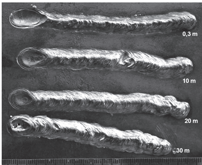
Figura 6. Cordões de solda realizados com o eletrodo E6013, com corrente de soldagem de 170A, em quatro profundidades diferentes (0,3 m, 10 m, 20 m e 30 m)
