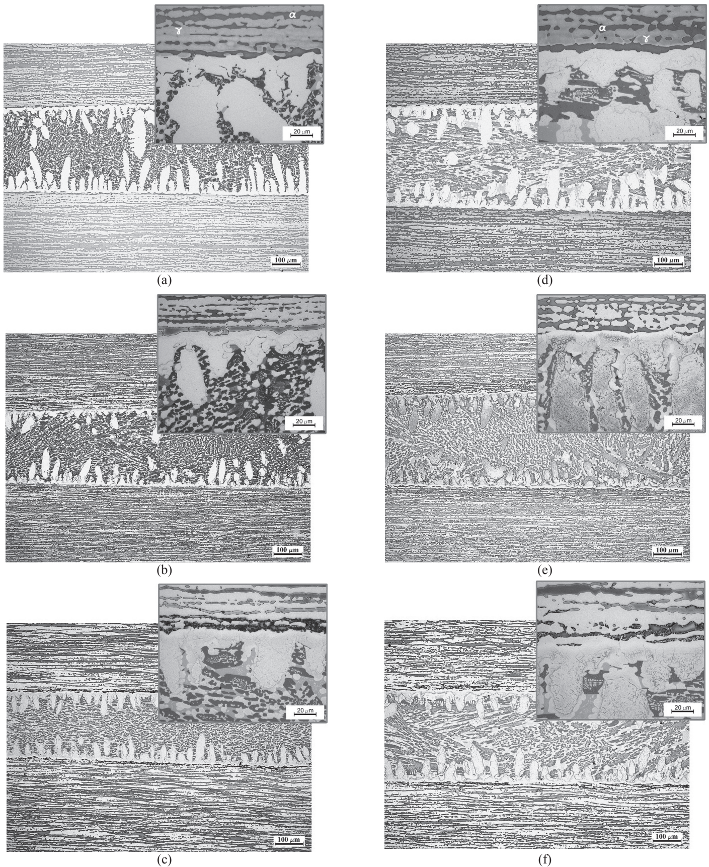
Figura 3. Microestrutura da junta brasada após ataque metalográfico obtida por microscopia óptica para os AID'S com o tempo de 12 min e folga máxima de 0,3 mm, (a) UNS S32101, (b) UNS S32304 e (c) UNS S32750 e (d) UNS S32101, (e) UNS S32304 e (f) UNS S32750 para o tempo de 32 min e folga de 0,3 mm.
