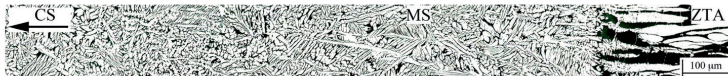
Figura 17. Microestrutura do MS-ZTAREA na zona de ligação. Ataque Beraha.
