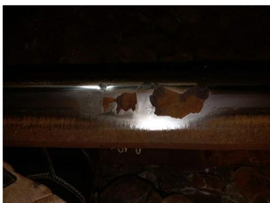
A. Ejemplo 1 de “squats” detectados en campo en la superficie de rodadura del riel.
