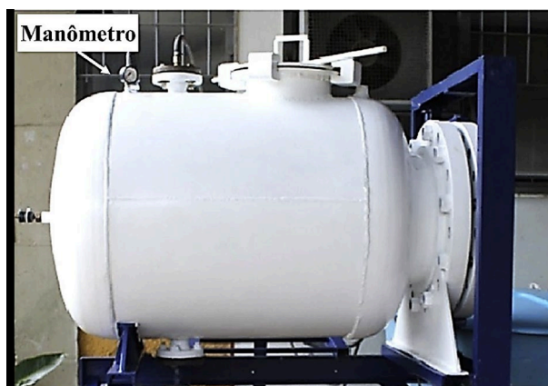
Figura 1. Tanque hiperbárico utilizado para soldagem em ambiente subaquático e pressurizado.
