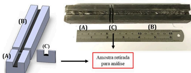
Figura 5. Corpo de prova cortado com destaque para a amostra retirada para análises (C) e partes restantes do corpo de prova (A e B).
