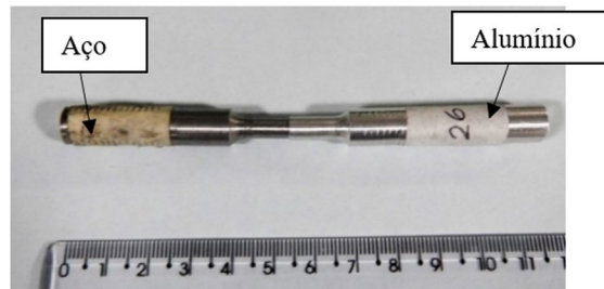
Figura 9. Corpo de prova usinado para ensaio de Tração.
