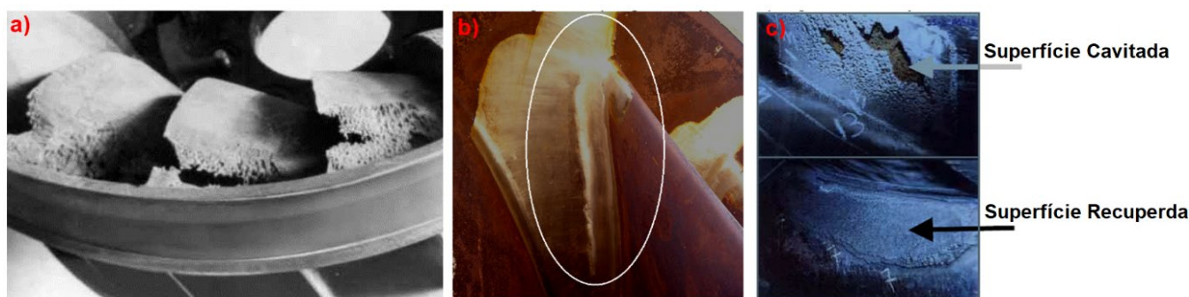
Figura 1. (a) Região com dano severo as pás do rotor de turbina tipo Francis, (b) Região recuperada após desgaste por cavitação, (c) Região com desgaste por cavitação e posterior recuperação por soldagem. Adaptado de [14,15].
