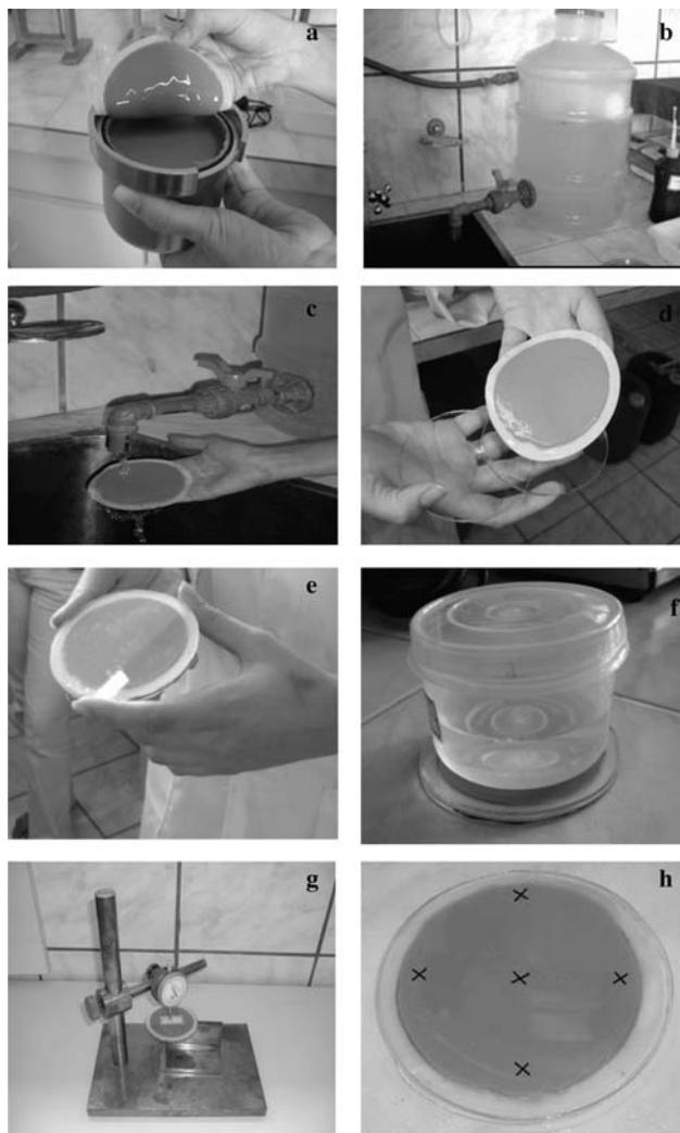
Figura 3: Etapas da metodologia utilizada para determinação da espessura do reboco.
