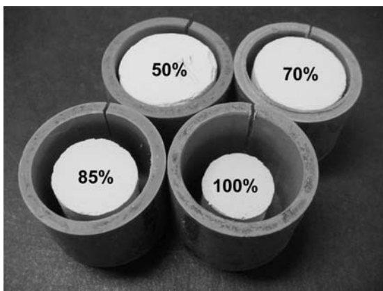
Figura 10: Visualização da retração volumétrica das amostras preparadas com os teores de 50%-v., 70%-v., 85%-v. e 100%-v. de hidrotalcita, queimadas a 1500 °C por 5 h.
