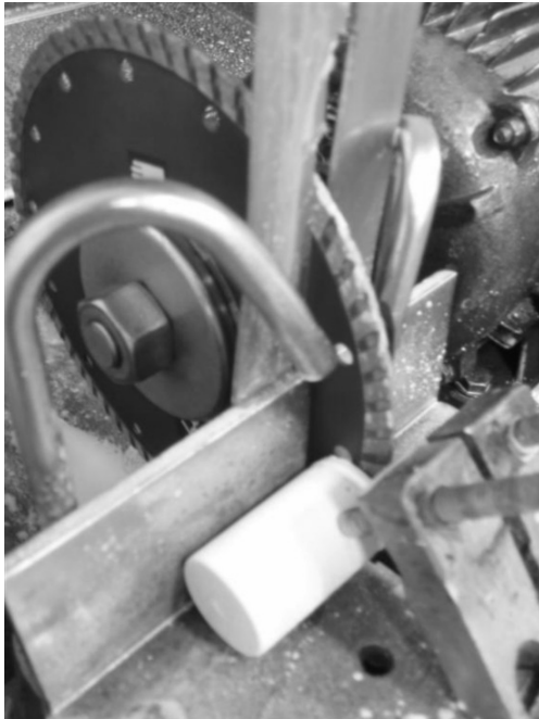
Figura 2: Corte dos corpos de prova dos compósitos estudados. [Figure 2: Cutting the composite specimens.]
