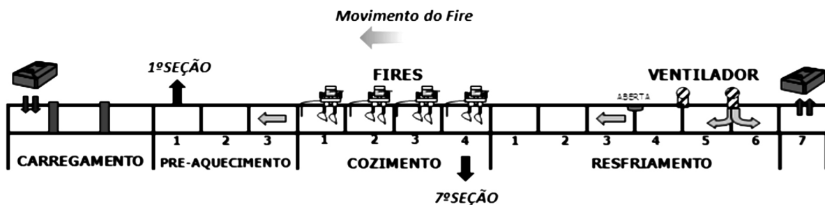
Figura 2: Projeto do sistema de queima ou Fire. [Figure 2: Firing system design or Fire.]
