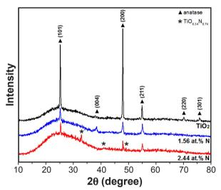
Figure 2: XRD patterns of undoped and N-doped TiO<sub>2</sub> films grown on borosilicate glass substrates at 400 °C by MOCVD. [Figura 2: Padrões de DRX dos filmes de TiO<sub>2</sub> não dopado e dopados com N crescidos sobre substratos de vidro borossilicato a 400 °C por MOCVD.]
