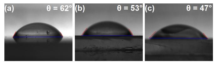
Figure 5: Images of contact angle measurements of undoped (a), and 1.56 at% (b), and 2.44 at% (c) N-doped TiO<sub>2</sub> films grown by MOCVD. [Figura 5: Imagens de medição de ângulo de contato dos filmes de TiO<sub>2</sub> não dopado (a), e dopados com 1,56 at% de N (b) e 2,44 at% de N (c) crescidos por MOCVD.]
