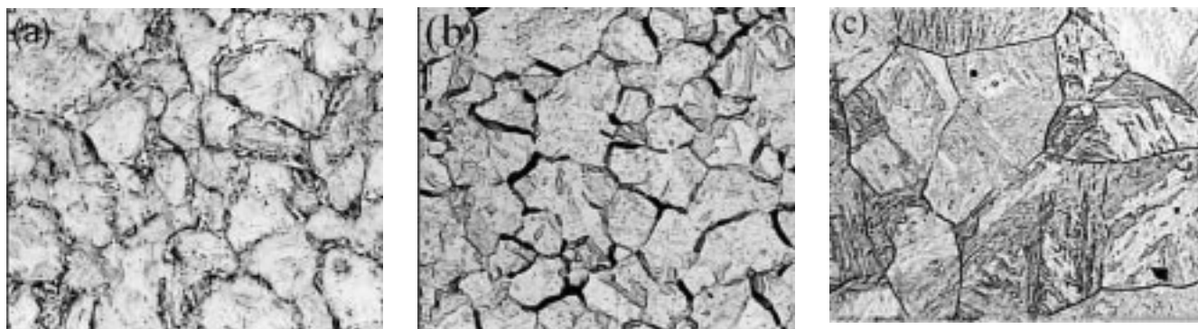
Figura 1 – Fotomicrografias revelando os contornos de grão austenítico, para as temperaturas de austenitização de a) 900, b) 1000 e c) 1100°C.
