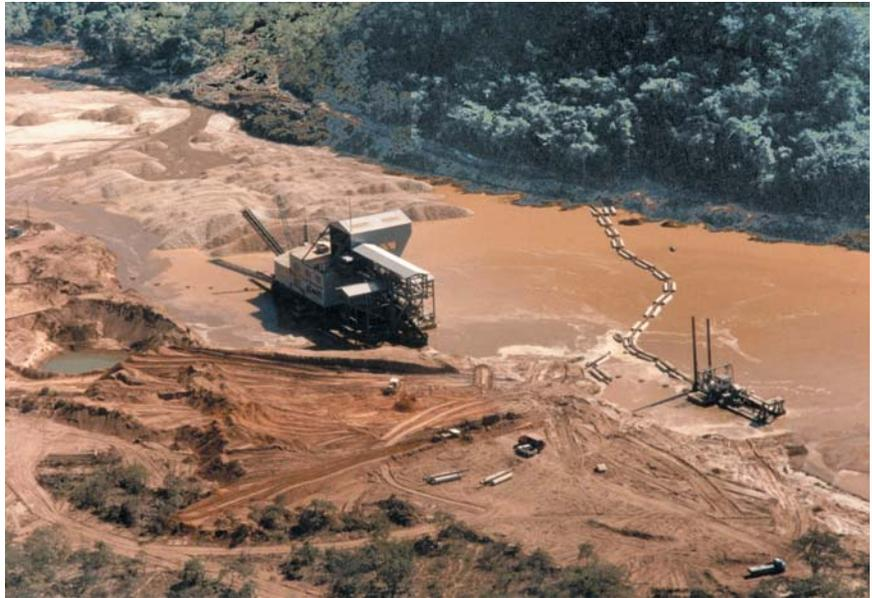
Figura 2 - Uma das dragas de alcatruzes em operação no depósito aluvionar do médio rio Jequitinhonha (“Maria Bonita”, à esquerda), tendo a frente (à direita) a draga de sucção do recobrimento arenoso estéril (foto cedida pela Mineração Rio Novo).
