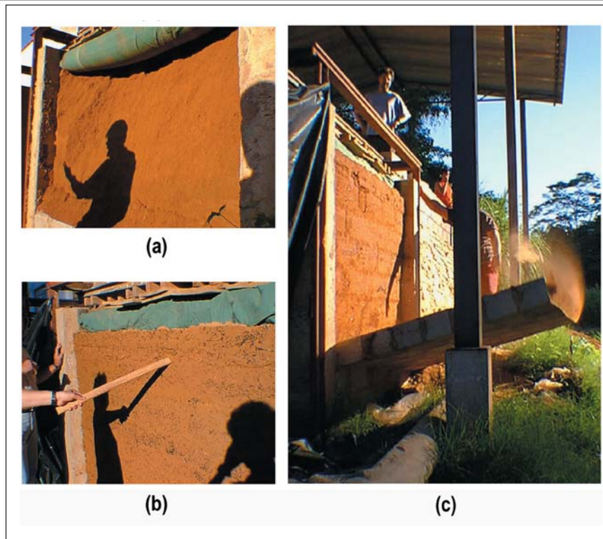
Figura 5 - Detalhes dos ensaios realizados com o solo e o fibrossolo: (a) vista da frente da caixa de ensaios para amostras de grandes dimensões, com visualização da amostra de solo, logo após o tombamento do muro de face do terrapleno; (b) vista da frente da caixa de ensaios para amostras de grandes dimensões, no momento do tombamento do muro de face do terrapleno de fibrossolo; (c) vista da frente da caixa de ensaios para amostras de grandes dimensões, com detalhe do terrapleno de fibrossolo após o tombamento do muro de face.
