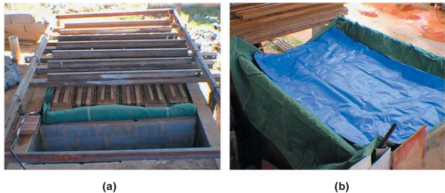
Figura 2 - Instalações físicas para a realização de ensaios em amostras de grandes dimensões: (a) vista superior da caixa de teste, com o sistema de reação e bolsa de carregamento em posição para a execução de ensaio; e (b) bolsa de reação, capacidade de 110 kPa, com lona protetora.
